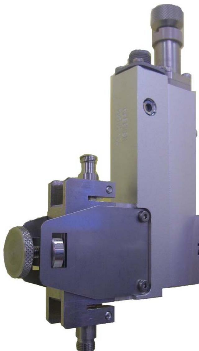
ノイベルクディスペンサTZ型は、積層型圧電素子駆動の3個のフィンガで、チューブを真っ直ぐに押し、チューブポンプ方式のディスペンサです。接液部がチューブのみで幅広い液剤に使用できます。コンピュータ設定により圧電素子にかかる電圧を制御し、吐出量の調整がデジタルに行えます。
